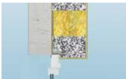
Nadproże okienne z pasem wełny mineralnej
