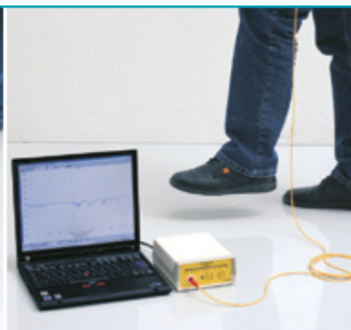
Fot. 3: Pomiar w teście chodzenia – walking test
