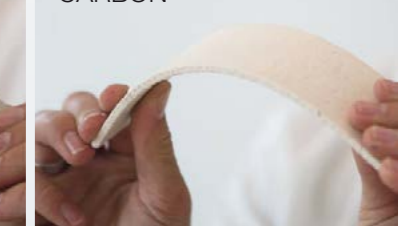
Warstwa zbrojona w systemie Capatect CARBON
