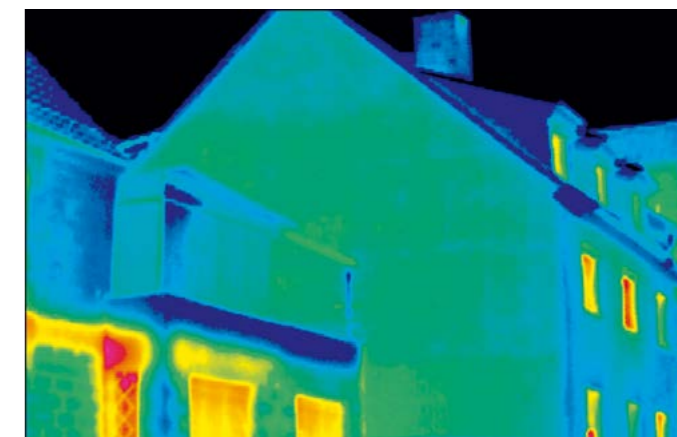
Straty energii: elewacja nieocieplona (po lewej) i ocieplona (po prawej)
