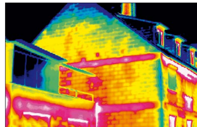
Straty energii: elewacja nieocieplona (po lewej) i ocieplona (po prawej)
